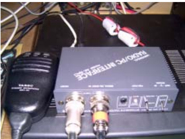
(写真 2 ノイズフィルタ TDK の NF-CS09 を電源とマイク出力に入れたて回りこみ対策をとった)
