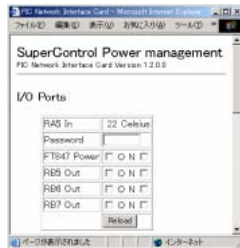
(図 4 PIC マイコンのアセンブラソースを変更してパスワードを追加した)
