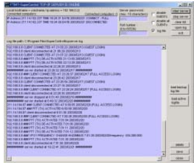
(図 13 接続やコマンドなどの詳細な記録が残せ、回線の切断を検知して送信を止めるなどなどアマチュア無線局審査基準の要求をすべて満たしている)
